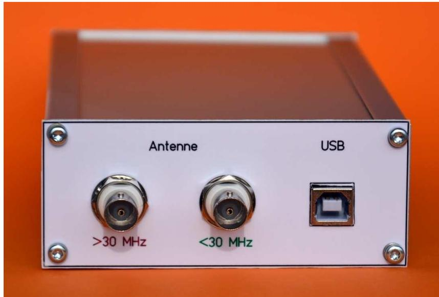
**Bild 20:** Die Rückansicht mit den Anschlussbuchsen
